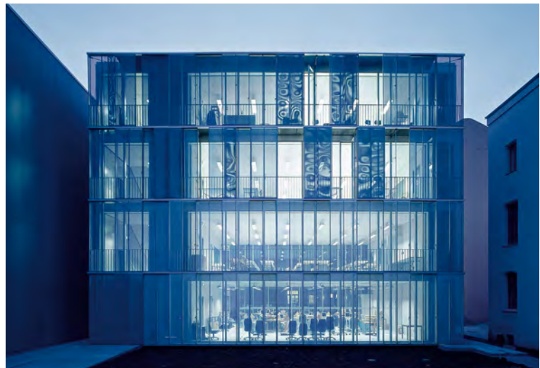
Die Flexibilität im Inneren der Häuser spiegelt sich in der Fassade wieder. Durch den Wechsel aus feststehenden und verschiebbaren Streckmetallelementen ändert sie sich mit den individuellen Bedürfnissen der Benutzer.
